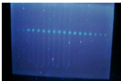
**Figura 2** - Padrão de OTA e extratos de amostras aplicados em placa cromatográfica, fase normal CCD, 10 x 20, 0,25 mm de espessura. Solvente de retomada do extrato: tolueno-ácido acético (99:1, v/v); solvente de eluição; tolueno-acetato de etila - ácido fórmico 88% (6:3:1, v/v/v).
