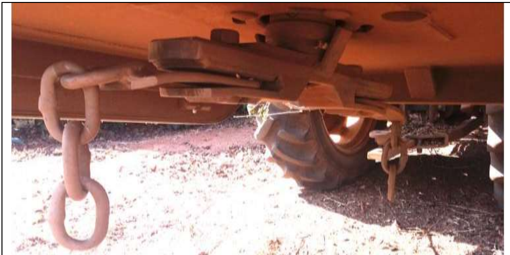
Pode-se ver a adaptação em roçadeira, com a soldagem de pequeno pedaço de corrente, na faca velha.
