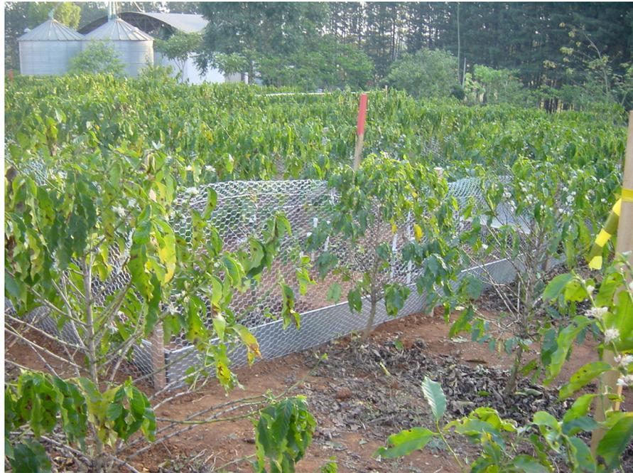
Figura 3.16. Ilustração das parcelas  $T_2$  delimitadas com chapa metálica para medição de escoamento superficial durante o cálculo do balanço hídrico e fechadas com tela metálica para evitar possíveis danos provocados por capivaras.
