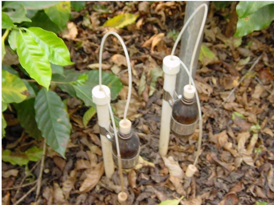
Figura 3.10. Vista dos extratores de solução do solo a vácuo instalados em cada parcela T<sub>2</sub> para o cálculo da quantidade de N lixiviada.
