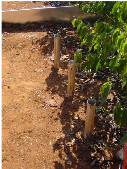
Figura 3.15. Detalhe dos 3 tubos de acesso para sonda de nêutrons instalados até a profundidade de 1,15 m em cada parcela  $T_2$  com o objetivo de medir a umidade do solo as profundidades de 0,2, 0,4, 0,6, 0,8 e 1,0 m.
