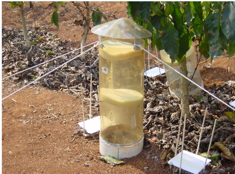
Figura 3.9. Detalhe do coletor semi-aberto-estático utilizado para quantificar a volatilização de amônia do solo.
