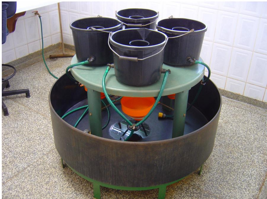
Figura 3.6. Aparelho utilizado para separação de raiz por lavagem.
