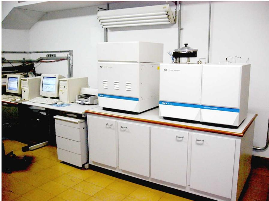
Figura 3.7. Espectrômetro de massa ANCA SL utilizado nas avaliações de N% e  $^{15}\text{N}$ .
