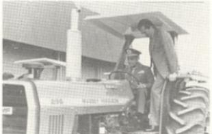
Um dos focos de maior interesse durante a visita foi o trator Massey Ferguson a álcool, o primeiro de sua categoria a utilizar somente álcool hidratado sem necessidade de qualquer aditivo. Este motor, criado e desenvolvido pela Engenharia da Perkins brasileira, combina a tradicional durabilidade do motor diesel com a conveniência do auto-abastecimento nas usinas produtoras de lcool e açúcar.
