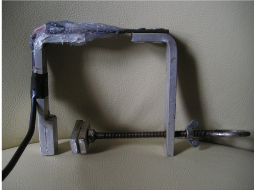
Figura 1. Foto ilustrativa do dendrômetro construído no LEAG/UENF, Campos dos Goytacazes - RJ, para o monitoramento do diâmetro do caule de plantas jovens de café.
