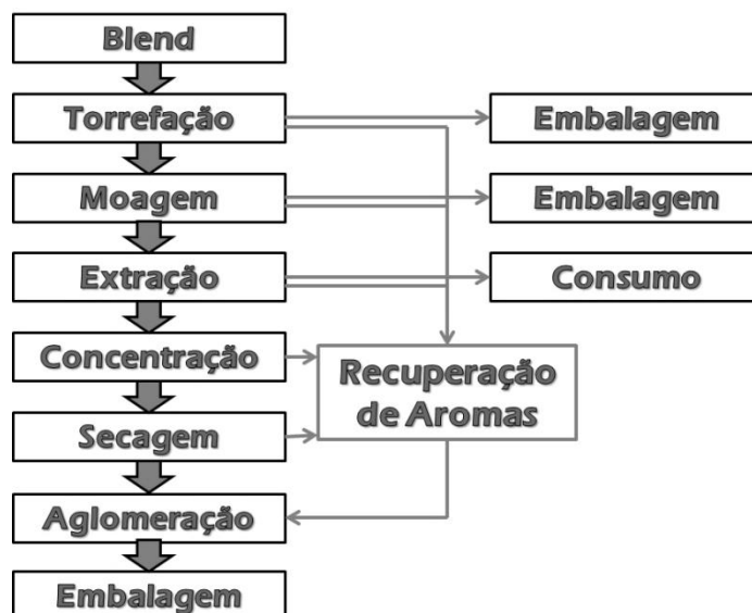
Figura 2.6: Etapas na transformação dos grãos verdes de café em bebida e na fabricação do café solúvel. Fonte: Adaptado de VARNAM e SUTHERLAND (1994).
