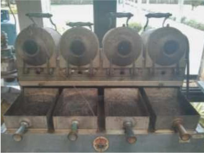
**Figura 11.** Torrador com cilindro rotativo
