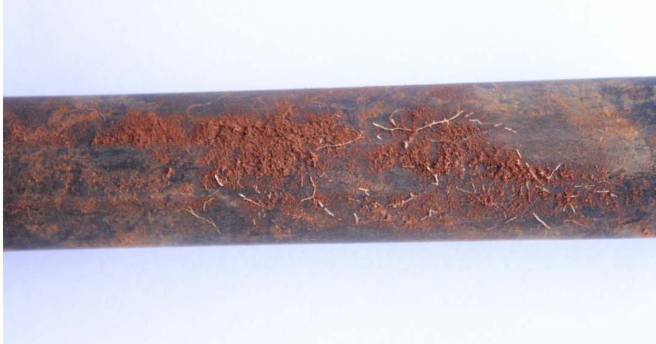
Figura 15 Presença de raízes de plantas daninhas na parte externa do tubogotejador
