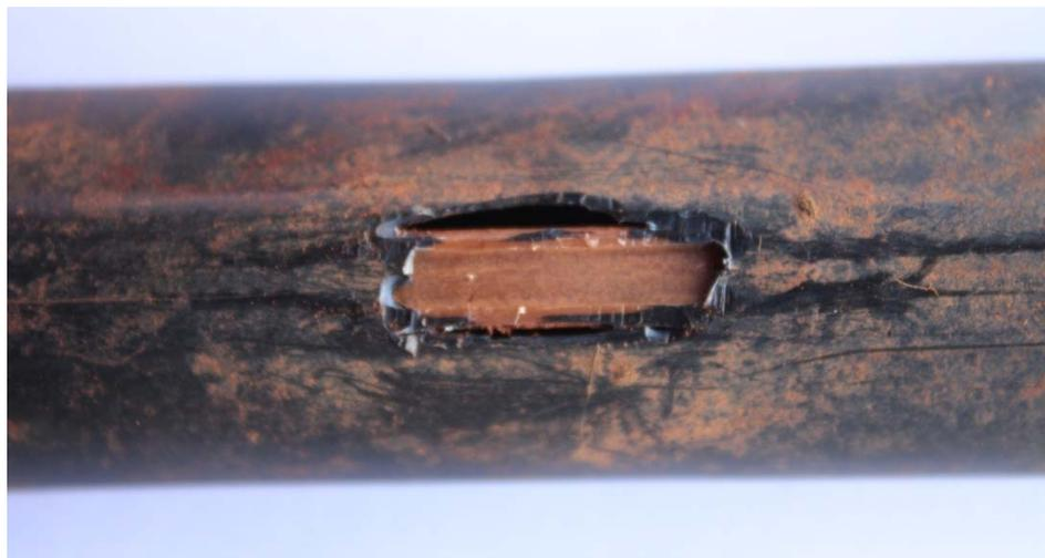
Figura 14 Detalhe de emissor sem obstrução por radicelas
