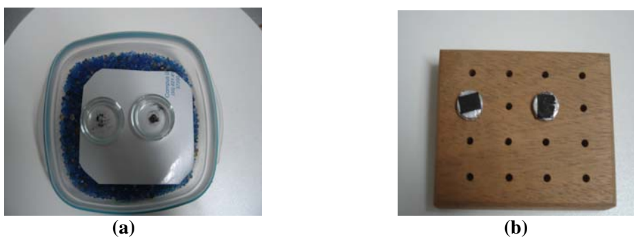
FIGURA 24. Preparação das amostras para MEV: (a) amostras no dessecador; (b) amostras em stubs .
