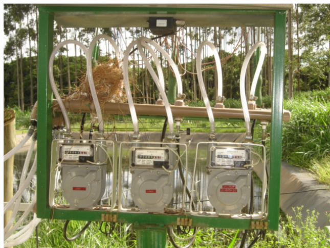
FIGURA 10. Vista parcial dos medidores de biogás utilizados para medição de biogás do sistema piloto de tratamento da água residuária do café, localizado no NECAF/UFLA.
