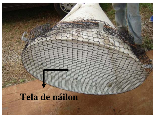
FIGURA 16. Separador trifásico do RAH localizado no NECAF/UFLA, com tela de náilon para evitar a penetração dos minifiltros.
