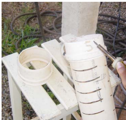
FIGURA 17. Minifiltro sendo marcado e enumerado com ferro de solda, no NECAF/UFLA.
