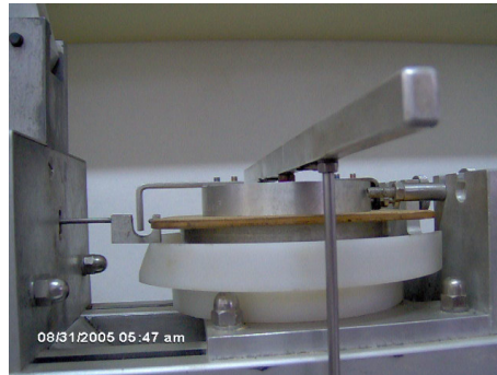
FIGURA 43 - Determinação do ângulo de atrito com a parede.
