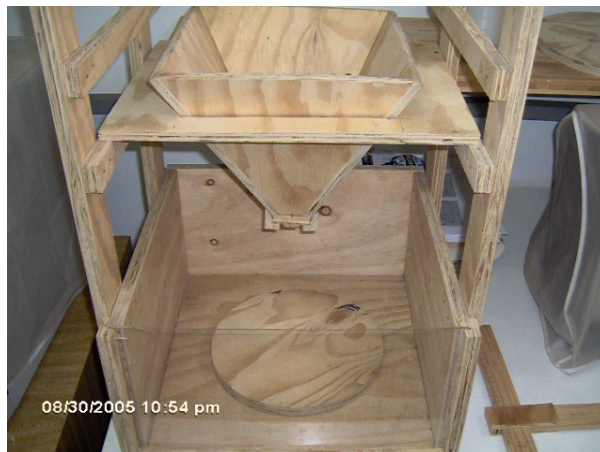
FIGURA 47 - Aparelho utilizado para a determinação do ângulo de repouso.
