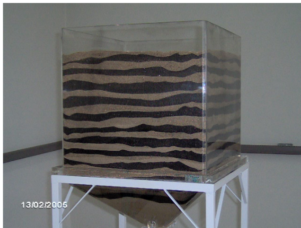
FIGURA 50 - Preenchimento em camadas para análise do fluxo.
