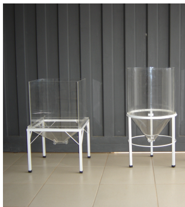
FIGURA 49 Silos protótipo de acrílico.
