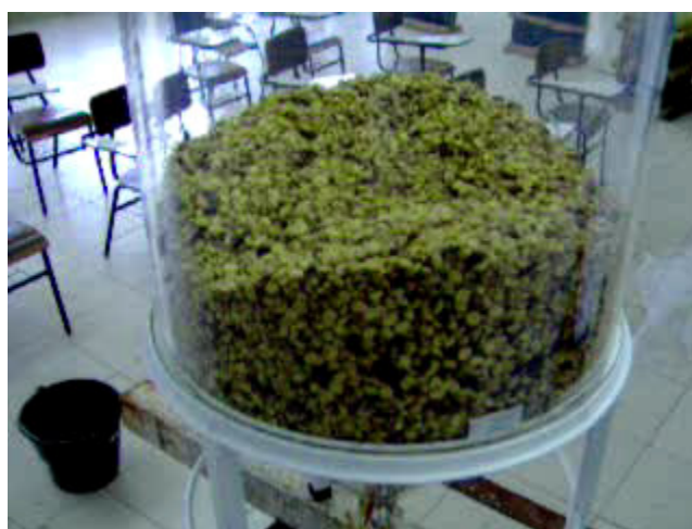
FIGURA 62 - Caracterização da superfície da massa de grãos durante o fluxo de massa.
