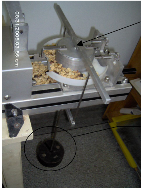
FIGURA 39 - Detalhe da etapa de pré-cisalhamento ou cisalhamento.
