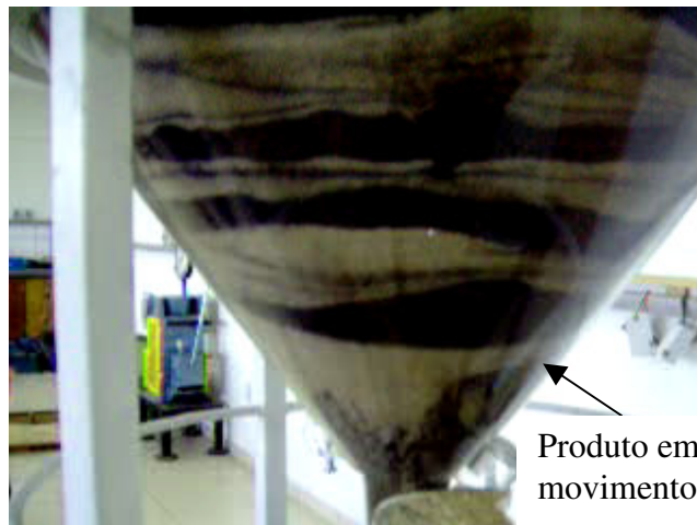
FIGURA 59 - Indicação da posição do produto durante o fluxo.
