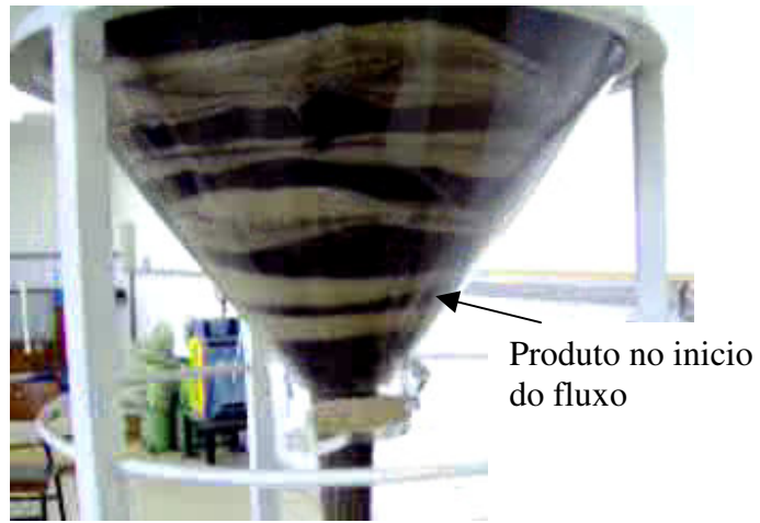
FIGURA 58 - Indicação da posição do produto no início do fluxo.
