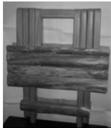
FIGURA 22 Banco confeccionado com madeira de Coffea arabica L. e Eucalyptus spp., em que: a = modelo aberto, b = modelo fechado.
