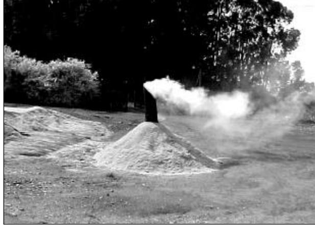
FIGURA 1- Método simples de carbonização da casca de arroz utilizando tubo metálico. UFLA, Lavras, MG, 2003.
