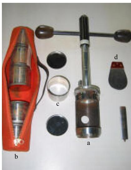
FIGURA 3.9 Trado (a) utilizado na coleta de amostras indeformadas e acessórios como (b) sacola com cilindros de aço de  $100\text{cm}^3$ , (c) cilindro com as tampas e (d) espátula para retirada do cilindro de dentro do trado.
