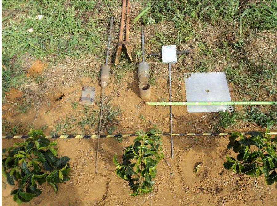
**Figura 3.** Equipamentos utilizados na avaliação da resistência mecânica do solo à penetração na linha de projeção do rodado; penetrômetro de impacto à esquerda e penetrômetro digital à direita.
