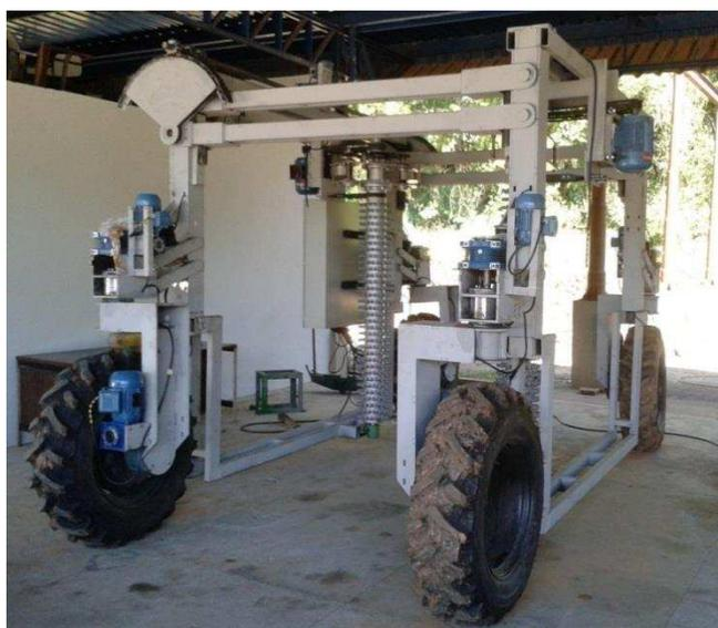
Figura 2 – Colhedora de café para terrenos montanhosos em desenvolvimento no LMA
