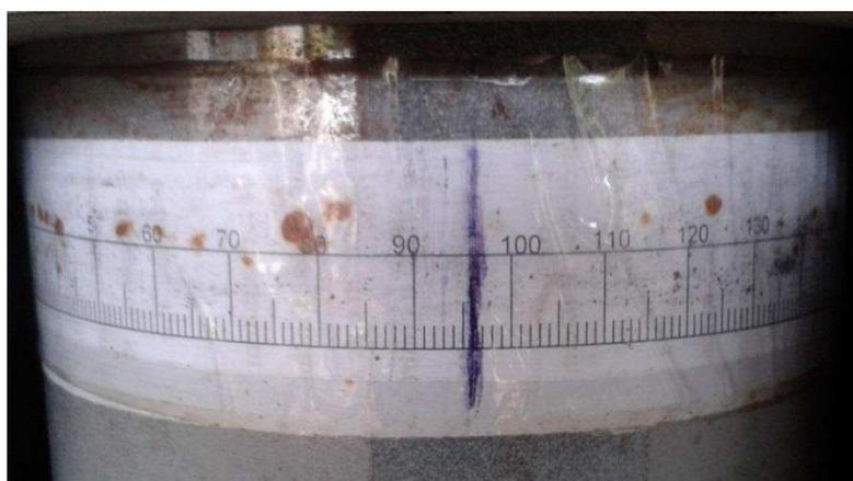
Figura 10 – Escala de marcação deslizante para marcação dos ângulos da roda
