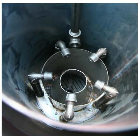
**Figura 3.3** - Detalhes das zonas de combustão e redução.
