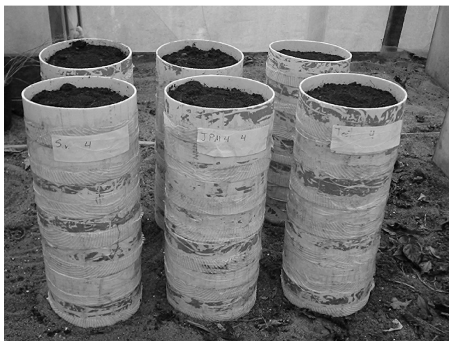
FIGURA 4 – Colunas de solo montadas com cilindros de PVC.
