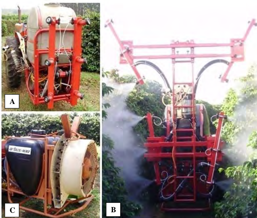
Figura 1. A. Primeira versão do pulverizador SMART, com 3 bocais pneumáticos em cada lado. B. Segunda versão do pulverizador SMART, com 6 bocais pneumáticos em cada lado. C. Pulverizador Arbus convencional para a cafeicultura, com 8 pontas de pulverização em cada lado.
