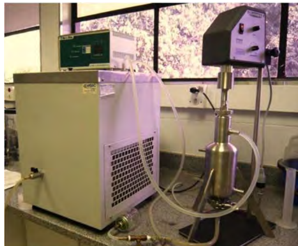
Figura 3-3. Fotografia do equipamento usado para extração com ultrassom.
