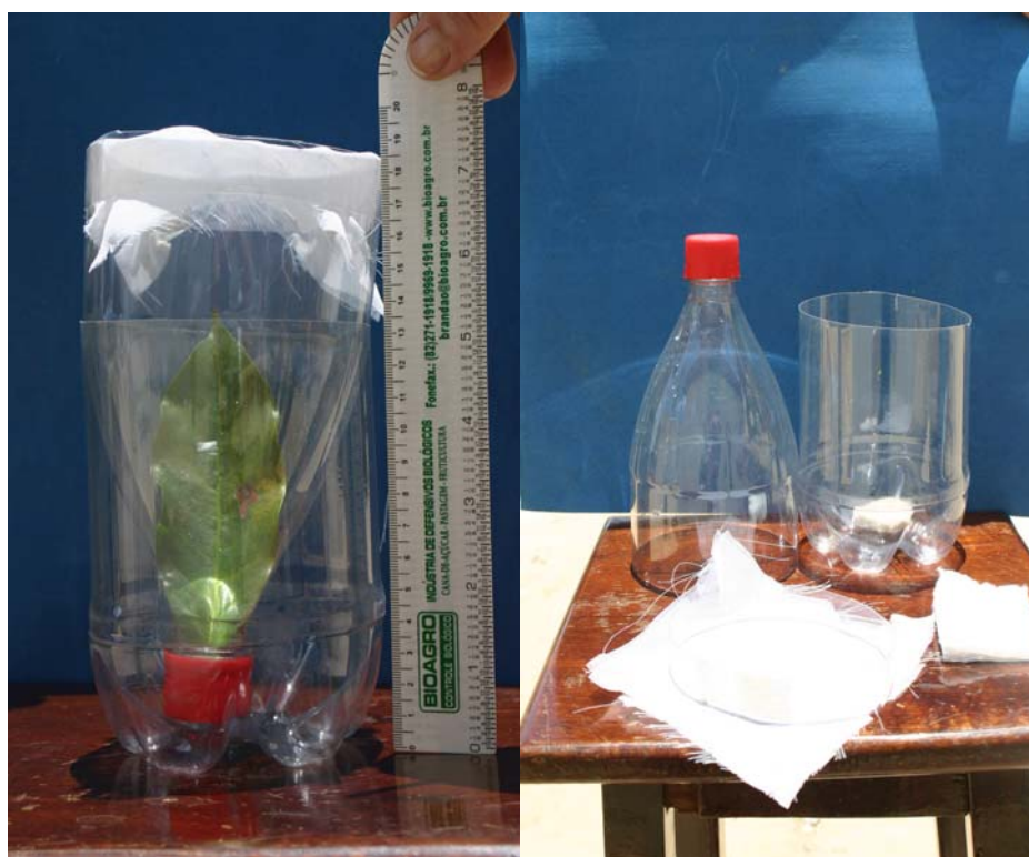
Figura 5 - Gaiolas confeccionadas com garrafa pet para acondicionamento de folhas visando a emergência de adultos. Vitória da Conquista, BA, 2005.
