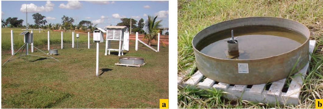
**FIGURA 2** - Estação Climatológica da Fazenda Experimental do Glória (a) e tanque “Classe A”, em detalhe (b).
