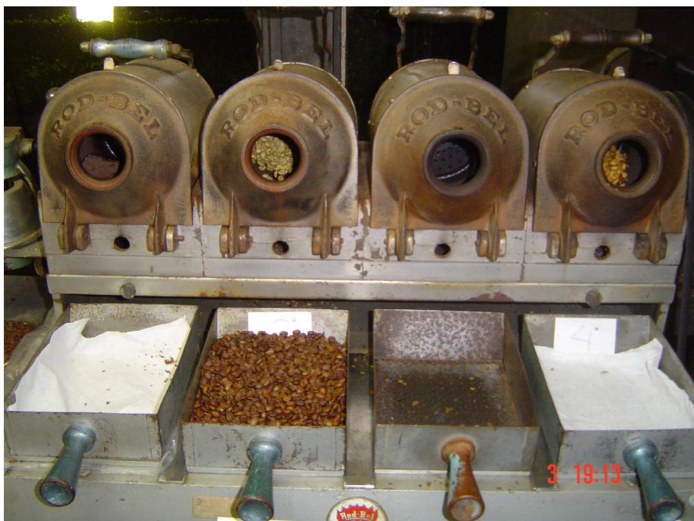
Figura 3.1. Torrefador de quatro cilindros rotativos com queima de gás direto.
