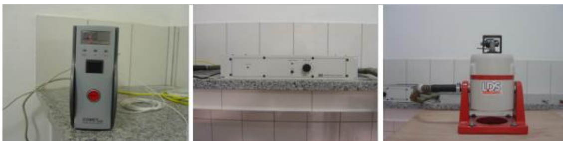
FIGURA 3.2 - Sistema empregado nos ensaios de derrixa: (a) gerador de sinais, (b) amplificador e (c) máquina vibradora (Fonte: SANTOS, 2008).
