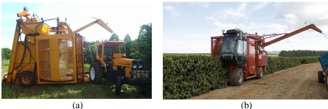
FIGURA 2.5 - Derriçadora tratorizada com um cilindro derriçador (a) e colhedora automotriz (b) utilizada para derriça dos frutos do cafeeiro (Fonte: MUNDO NOVO ALIANÇA, 2012 e CASE IH, 2012).
