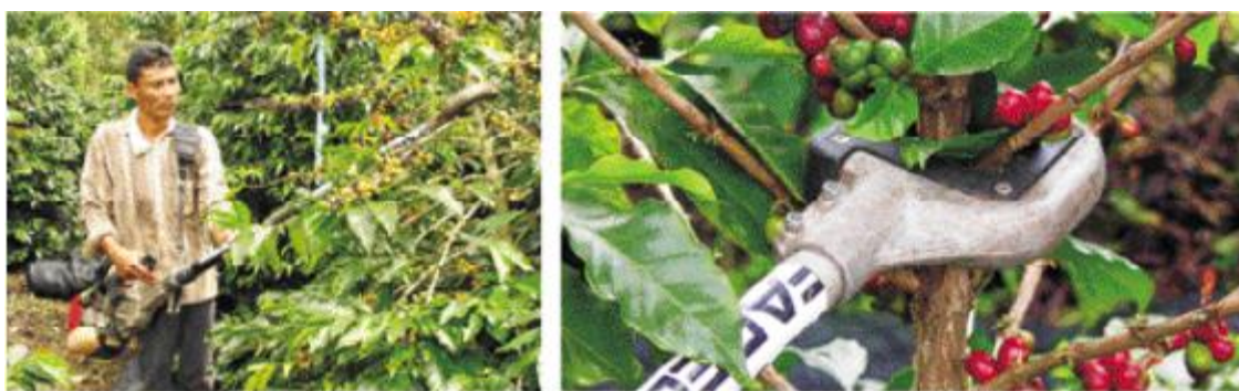
FIGURA 2.3- Derriçador portátil que aplica vibração aos ramos plagiotrópico do café a fim de promover o desprendimento dos frutos (Fonte: TASCÓN et al. , 2005).
