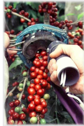
FIGURA 2.7 - Aplicação combinada de torção e flexão ao sistema fruto-pedúnculo do café (Fonte: GOMEZ & TÁSCON, 2003).
