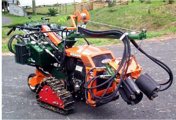
FIGURA 2.1 - Dispositivo agitador com padrão multidirecional para troncos de plantas de café desenvolvido pelo CENICAFE (2001) (Fonte: GARCÍA-URIBE & OLIVEROS-TASCÓN, 2003).
