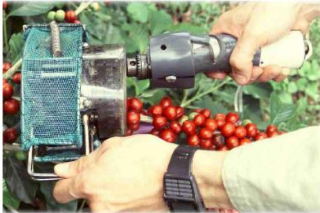
FIGURA 2.7 - Aplicação combinada de torção e flexão ao sistema fruto-pedúnculo do café (Fonte: GOMEZ & TÁSCON, 2003).
