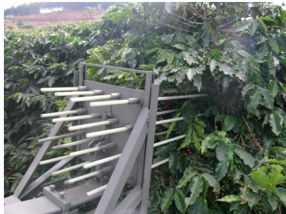
FIGURA 2.6 - Dispositivo para derrça de frutos de café aplicando vibração aos galhos por meio de hastes vibratórias em movimento vertical (Fonte: OLIVEIRA, 2009).
