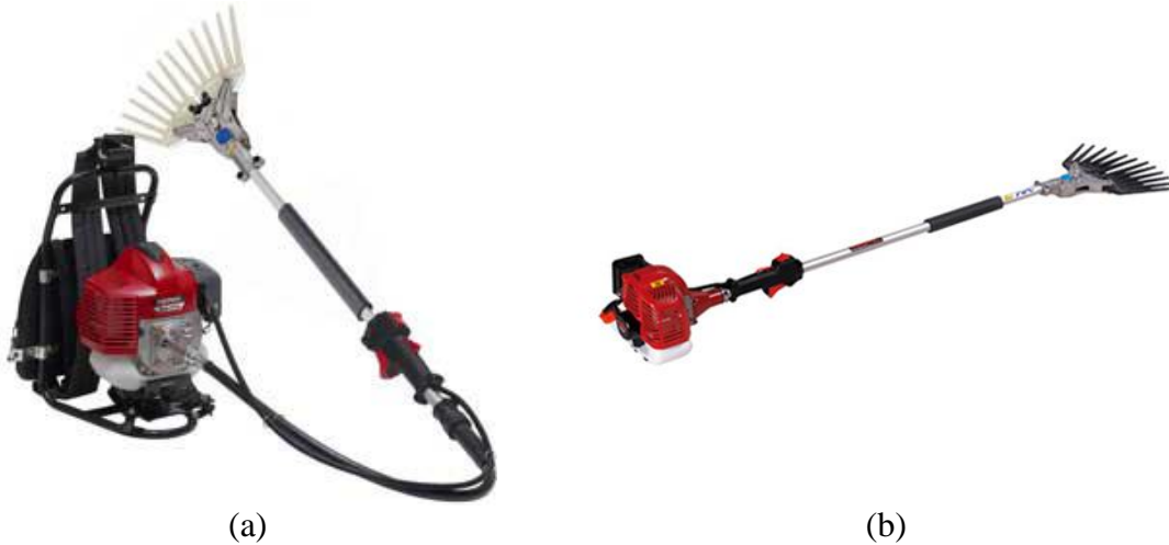
FIGURA 2.4- Derriçadoras portáteis utilizadas para derriça dos frutos do cafeeiro (a) costal e (b) lateral (Fonte: NAKASHI, 2012).
