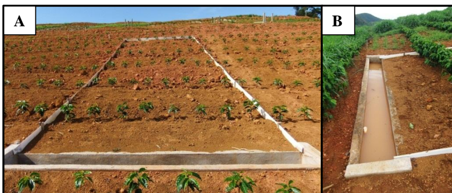
Figura 2: Parcela coletora de água e solo perdidos por escoamento superficial em área em recuperação com cafeeiro após mineração de bauxita. A) contorno da parcela coletora com chapas de PVC; B) caixa coletora construída em concreto.
