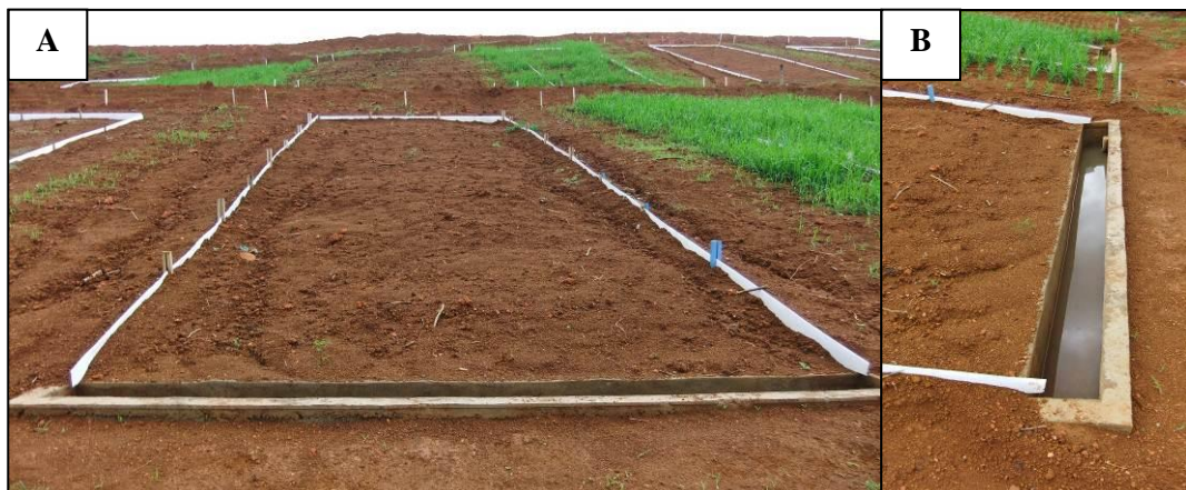
Figura 2: Parcela coletora de água e solo perdidos por escoamento superficial em área em recuperação com pastagem após mineração de bauxita. A) contorno da parcela coletora com chapas de PVC; B) caixa coletora construída em concreto.
