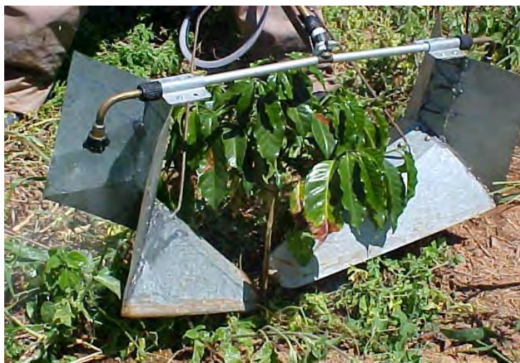
Figura 15. Barra de pulverização com o dispositivo protetor.
