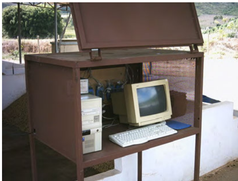
Figura 10 – Vista do sistema de aquisição de dados empregado para o monitoramento da temperatura e da umidade relativa do ar nos terreiros secadores.
