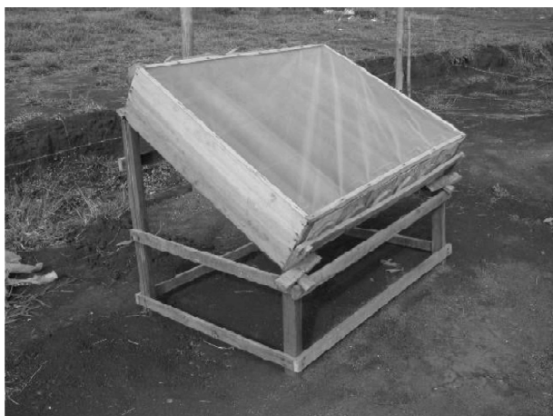
Figura 1 – Coletor Solar, para desinfestação de substratos (junho de 2004).
