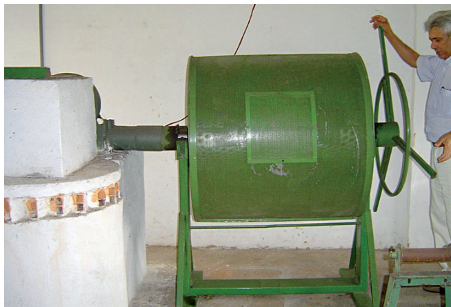
Figura 7a. Vista lateral do protótipo do novo secador rotativo com rotação intermitente.
