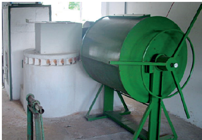
Figura 7b. Vista geral do protótipo do novo secador rotativo com rotação intermitente.
