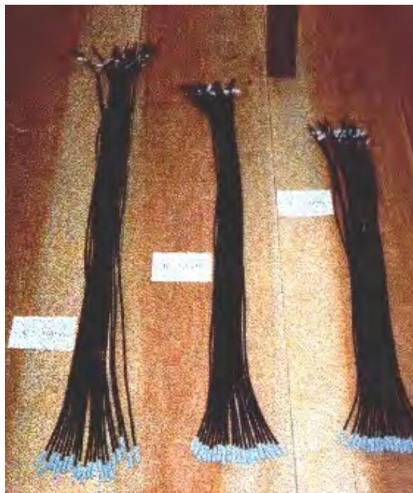
Figura 6 - Acoplagem dos sensores para as diferentes alturas de 0, 15 e 30 cm.
