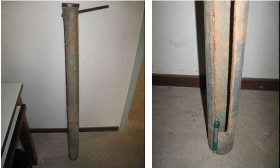
Figura 1. Trato tipo sonda utilizado na amostragem do sistema radicular do cafeeiro.
