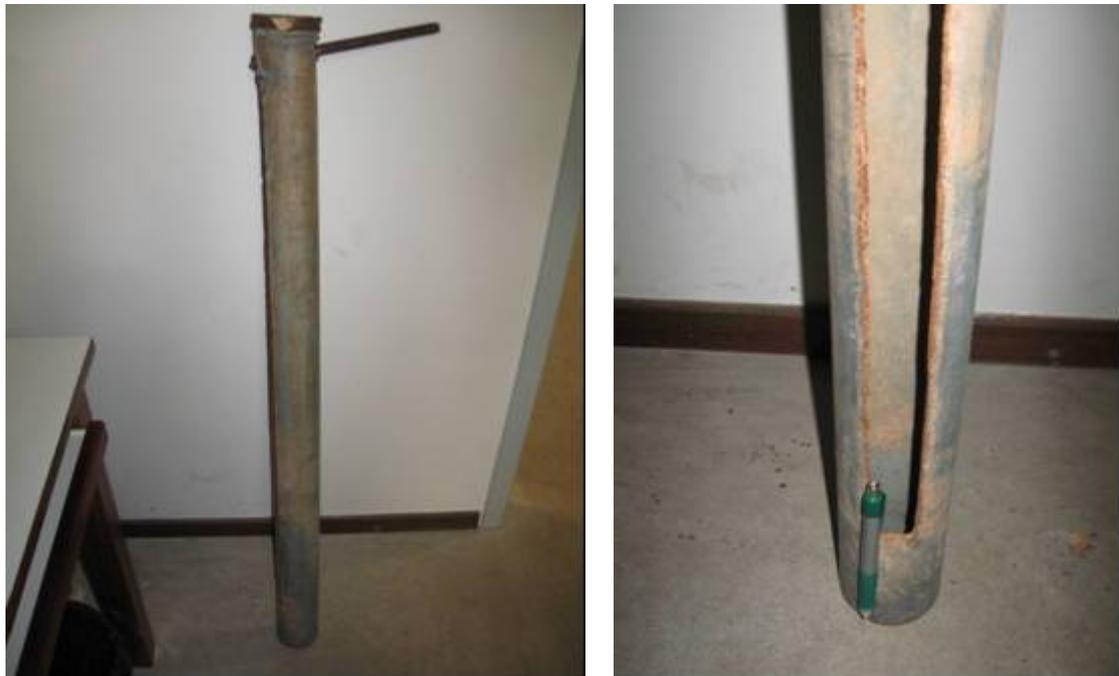
Figura 1. Trado tipo sonda utilizado na amostragem do sistema radicular do cafeeiro.
