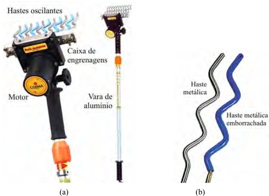
Figura 1 - Derriçadora portátil ensaiada (a) e detalhe das hastes curvilíneas oscilantes (b).
