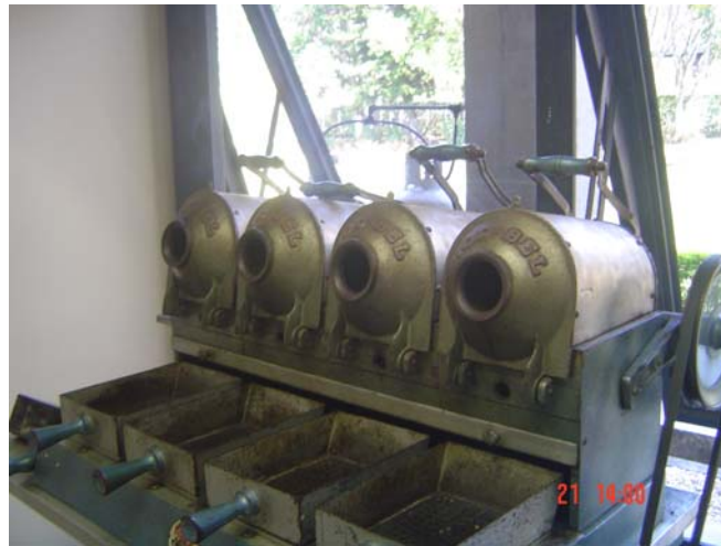
Figura 1 - Torrefador a gás de quatro cilindros rotativos de combustão direta.
