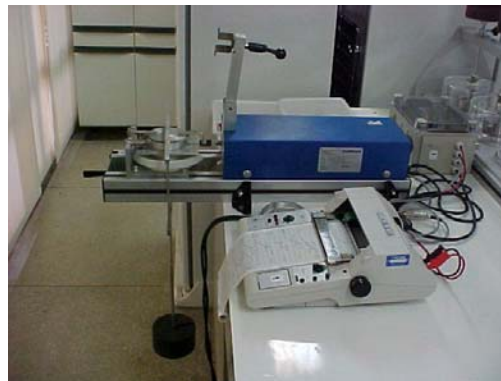
Figuras 1 e 2. Aparelho de cisalhamento de Jenike, vista superior(1) e lateral (2).
