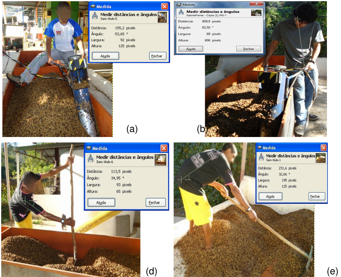
FIGURA 3. Determinação do ângulo dos segmentos corporais durante o revolvimento mecanizado nas posturas do (a) Protótipo 1 , (b) Protótipo 2 e dos revolvimentos manuais (c) com e (d) sem restrição lateral da câmara de secagem, utilizando o software Gimp.
