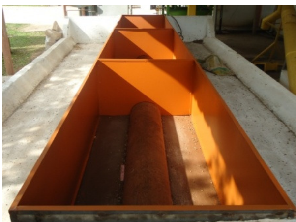
FIGURA 5. Secador de camada estacionária sem e com restrição lateral da câmara de secagem do secador.
