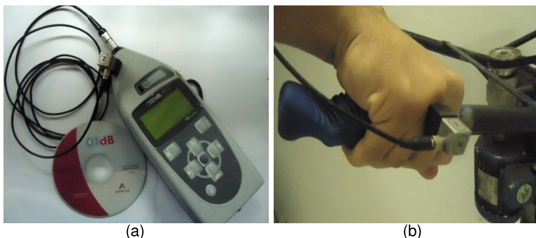
FIGURA 2. (a) MAESTRO 01 DB e (b) disposição da montagem do acelerômetro medidor de vibração triaxial no revolvedor.
