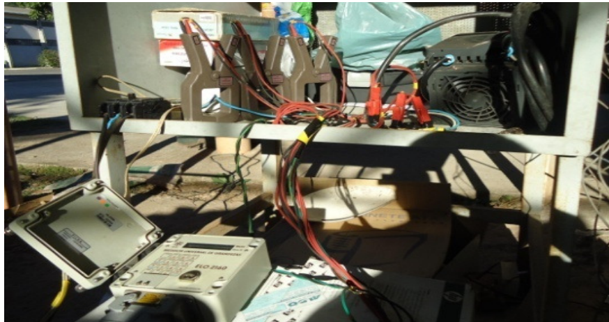
FIGURA 3. Montagem do MUG e Inversor de frequência durante os ensaios.
