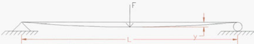
Figura 2 - Esquema do teste de flexão para galhos de café.
