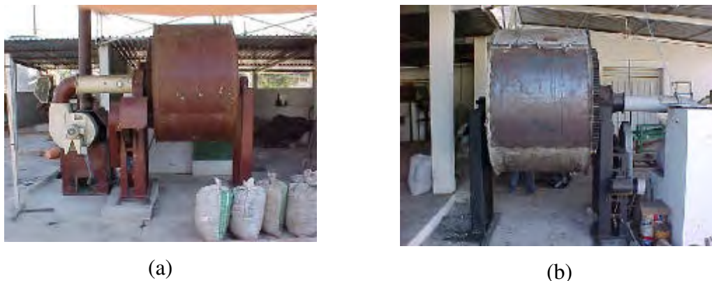
Figura 2 – Secador rotativo comercial (a) e modificado (b).
