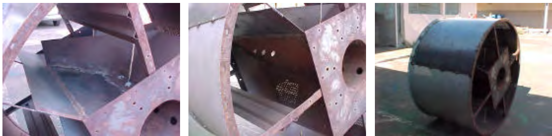
Figura 4 – Detalhes das modificações ocorridas no secador rotativo
