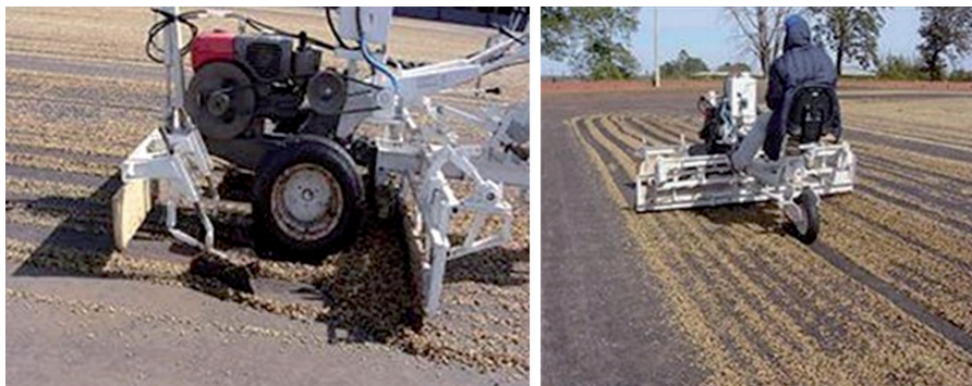
Figura 9. Equipamento raspador-enleirador de café (à esquerda) e revolvimento do café no terreiro (à direita).
