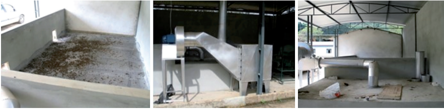
Figura 14. Secador-caixa, com fundo de tela de arame (à esquerda), fornalha de fogo indireto (ao centro) e ventilador centrífugo (à direita).
