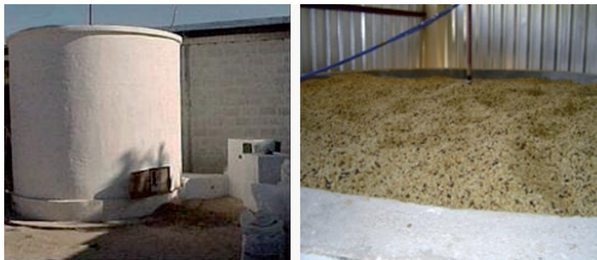
Figura 18. Tulhas de café: com sistema de ventilação para secagem em silos em baixas temperaturas (à esquerda); visão superior do café na tulha ventilada (à direita).
