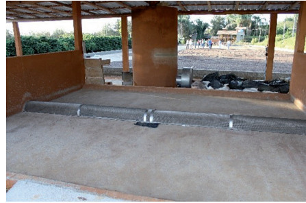
Figura 12. Tela de distribuição do ar em terreiro secador (à esquerda) e terreiro secador com as leiras de café (à direita).
