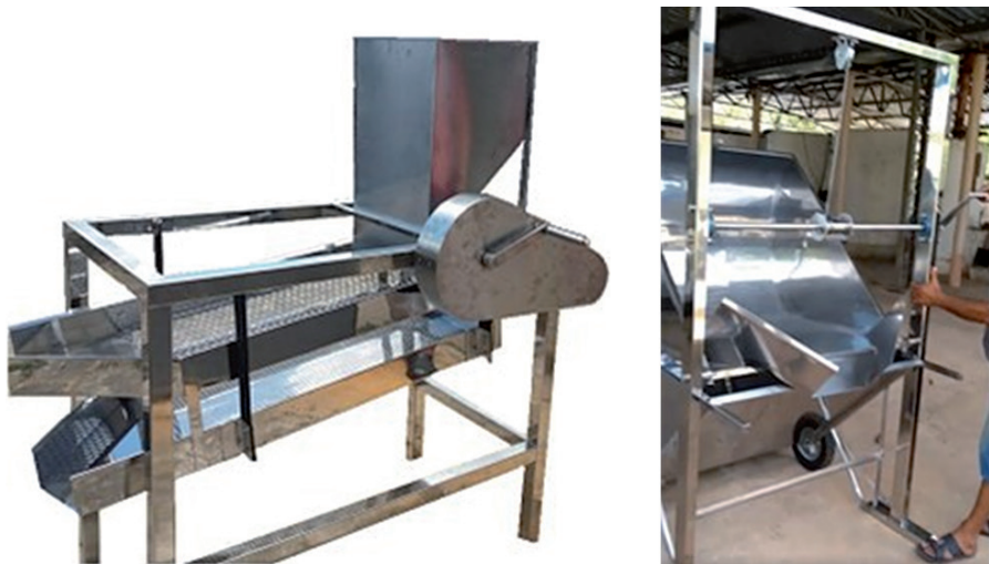
Figura 3. Máquina para separar folhas do fruto no campo (à esquerda). Lavadora portátil de café (à direita).
