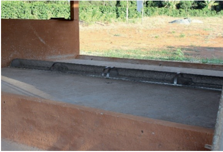
Figura 12. Tela de distribuição do ar em terreiro secador (à esquerda) e terreiro secador com as leiras de café (à direita).
