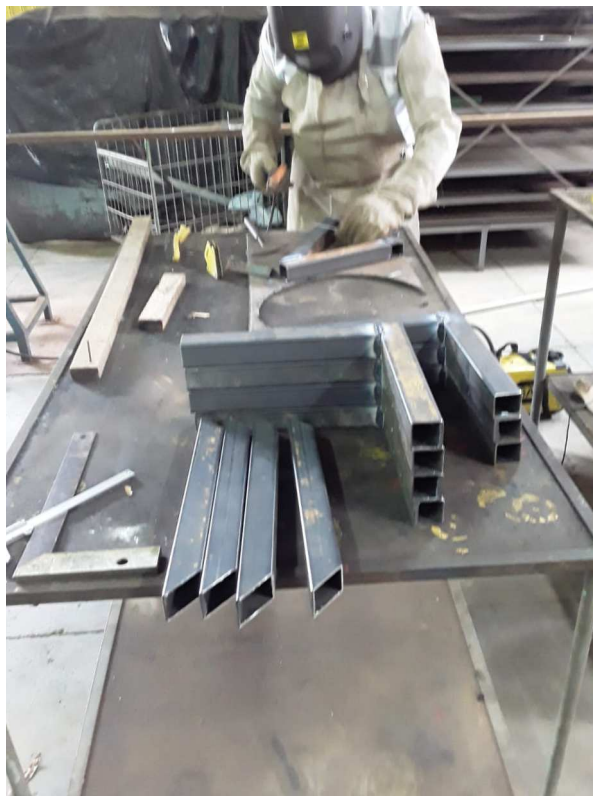
Figura 19 – Construção dos suportes do sistema regulador da recolhedora autopropelida
