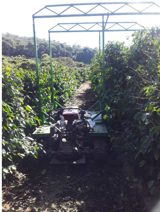
Figura 25 – Procedimento experimental realizado na fazenda Oásis. (a) deslocamento do protótipo nas ruas do cafezal, (b) ação do mecanismo recolhedor e (c) ação dos dedos retráteis
