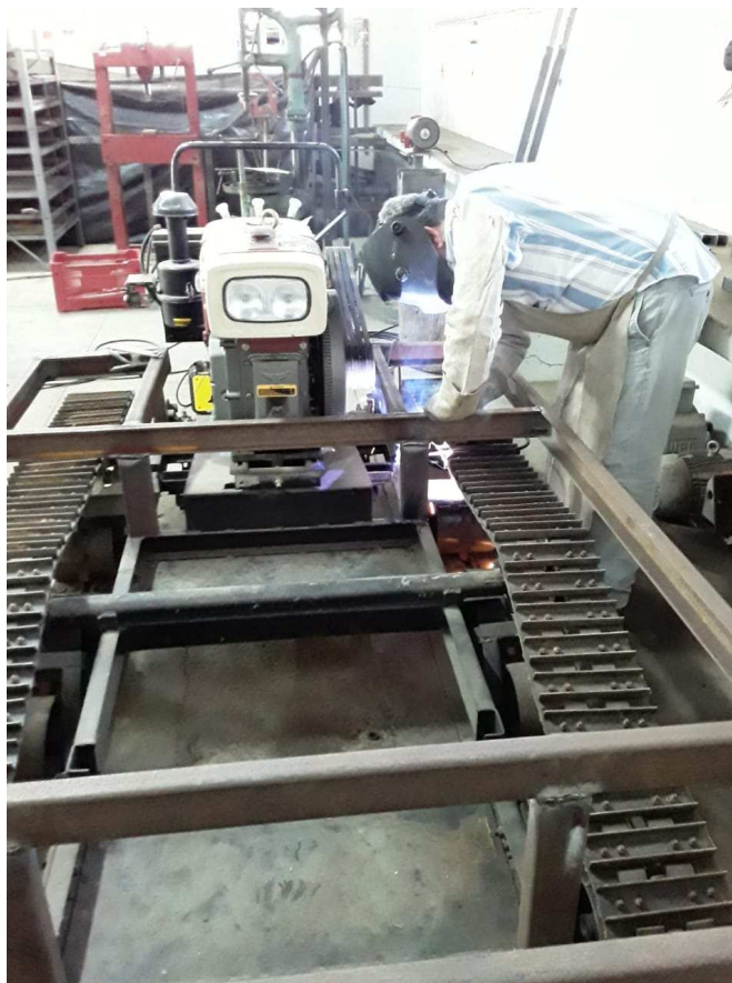
Figura 18 – Construção da extensão do chassi do protótipo
