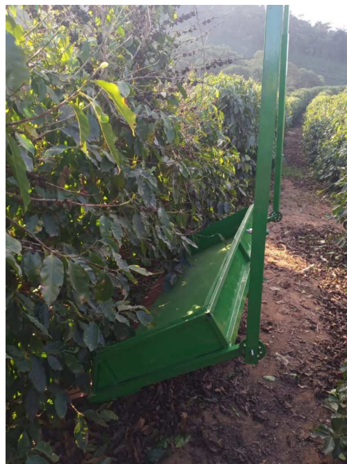
Figura 25 – Procedimento experimental realizado na fazenda Oásis. (a) deslocamento do protótipo nas ruas do cafezal, (b) ação do mecanismo recolhedor e (c) ação dos dedos retráteis
