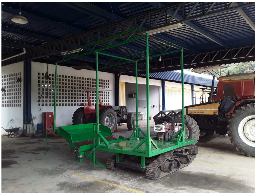
Figura 23 – Montagem completa da recolhedora autopropelida para colheita de café em região de montanha terraceada
