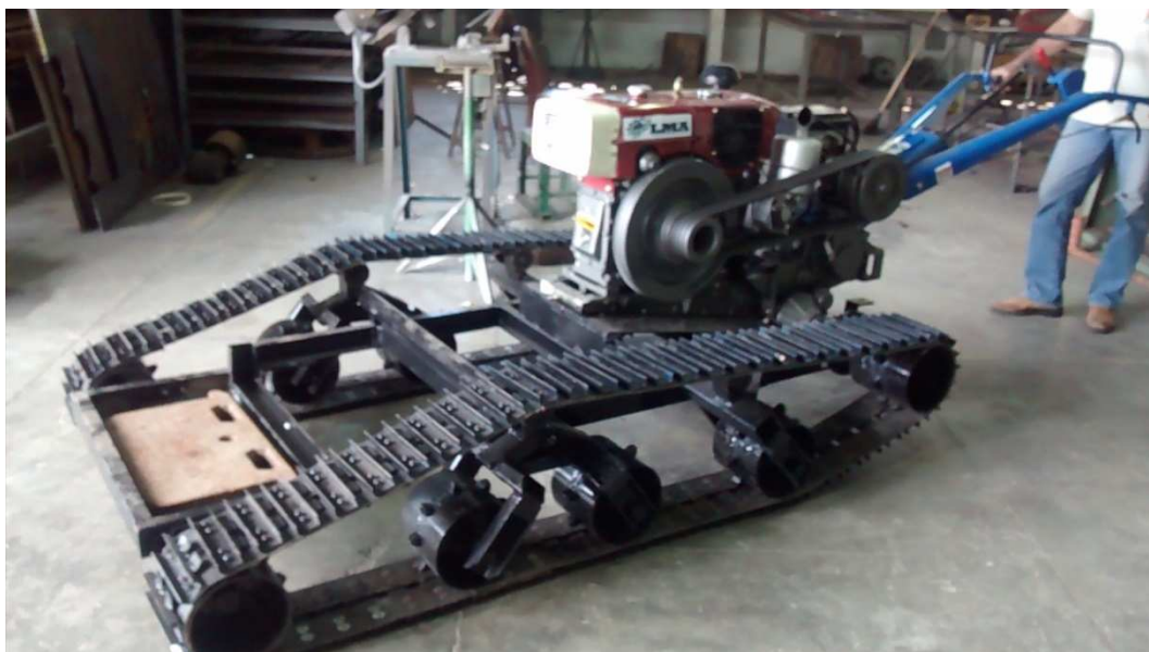
Figura 2 – Protótipo da plataforma para locomoção de recolhedora de café em regiões de montanha
