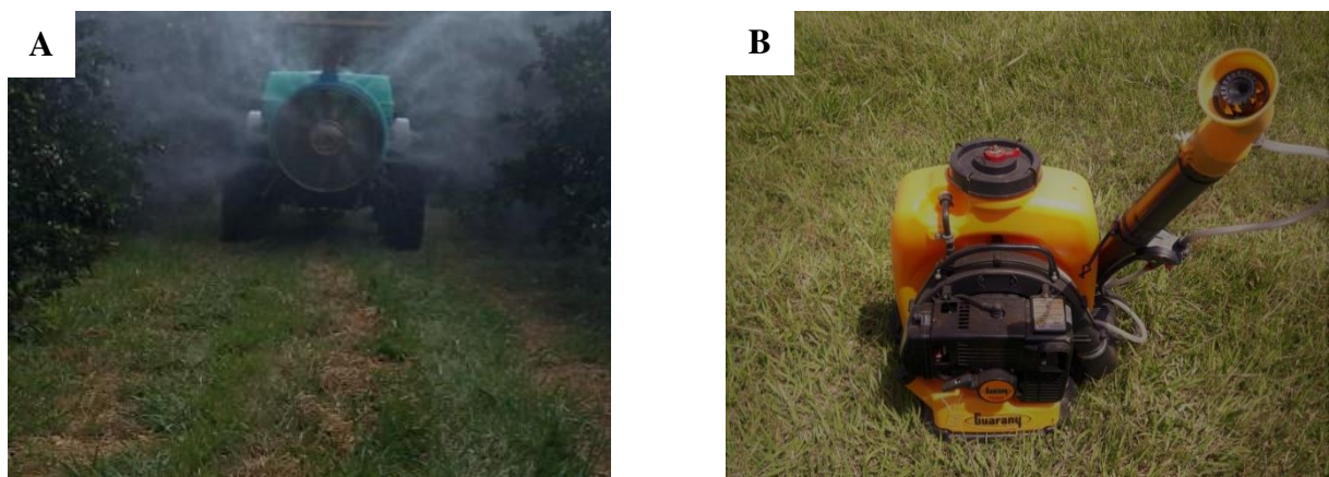
Figura 4. Pulverizador hidropneumático tratorizado (A) e pulverizador pneumático costal (B) utilizados para avaliação da capacidade operacional.
