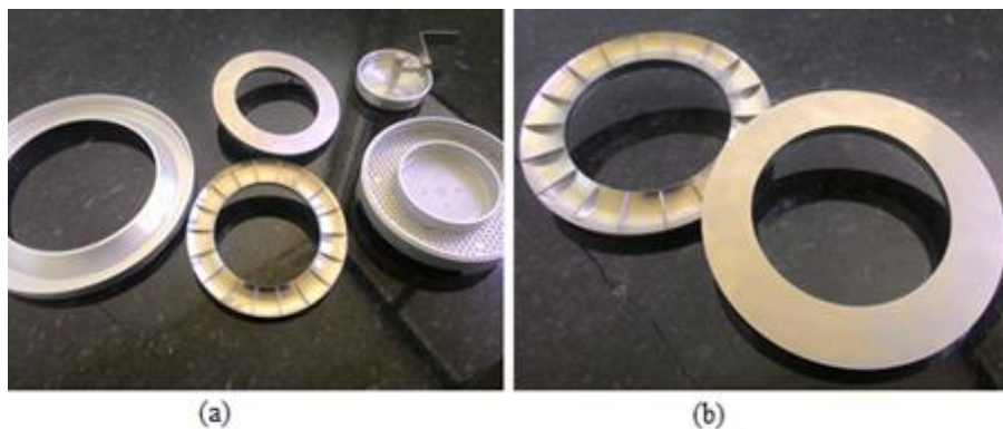
Figura 30 - Peças do aparelho “Powder Flow Tester”. (a) Peças que compõem a célula de cisalhamento rotacional. (b) Anel 1 (anel de cisalhamento na opção Função Fluxo); Anel 2 (anel de atrito com a parede).
