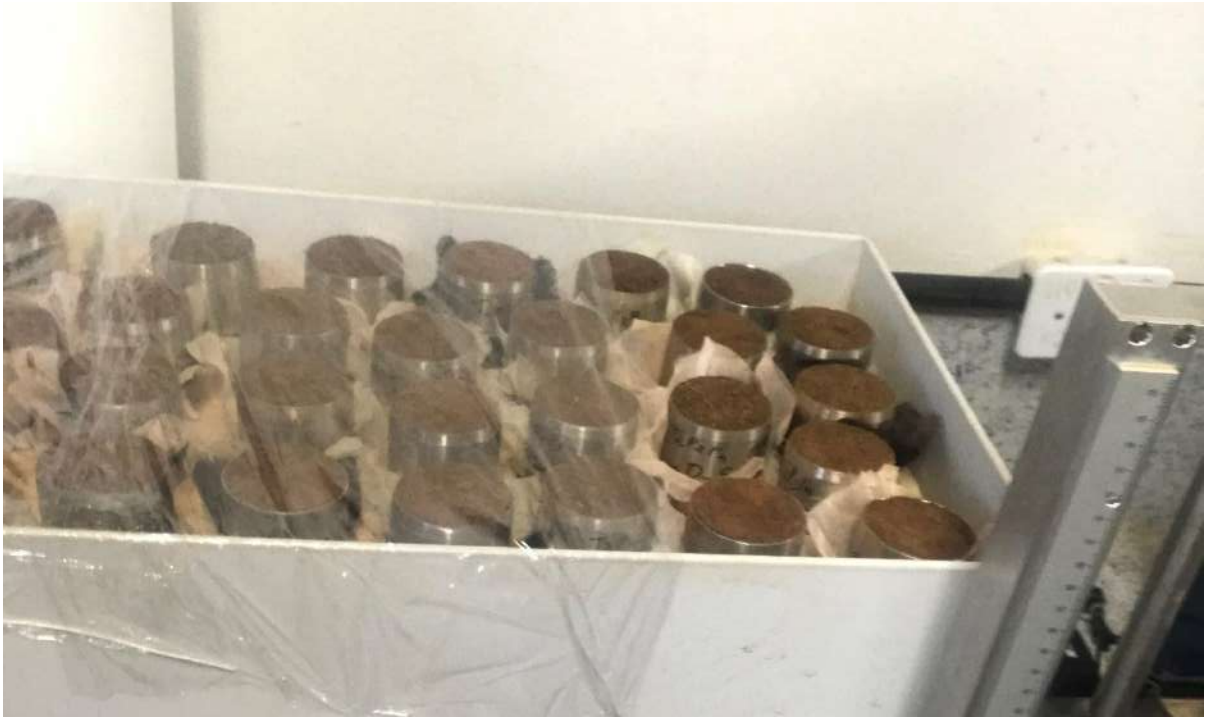
Figura 8. Amostras indeformadas colocadas na mesa de tensão para determinação da porosidade do solo. Rio Paranaíba – MG.
