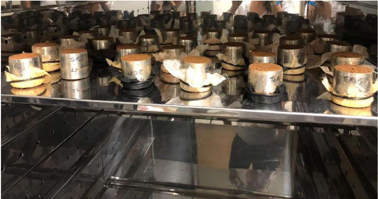
Figura 9. Amostras indeformadas colocadas em estufa de ar de circulação forçada. Rio Paranaíba – MG.
