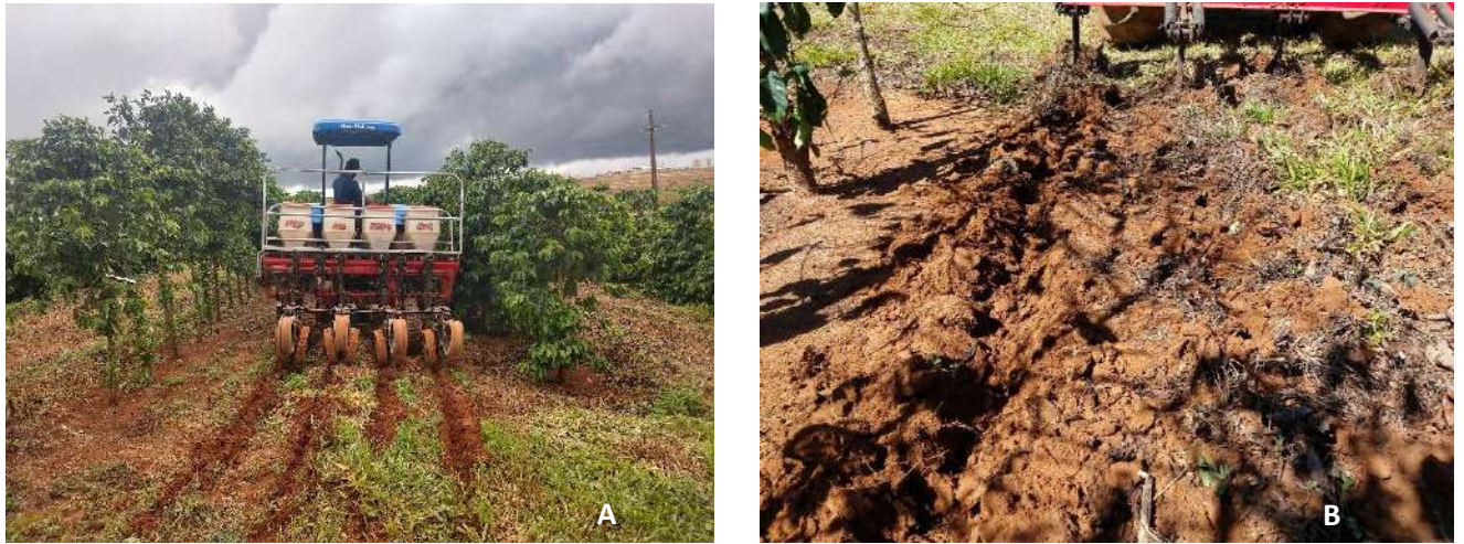
Figura 5. Abertura de sulcos para adubação mecanizada e semeadura manual das plantas de cobertura na entrelinha do cafeeiro utilizando uma semeadora /adubadora Jumil modelo MG05 PLVO4L (A) e escarificação mecânica do tratamento sem cobertura vegetal do solo (B). Rio Paranaíba – MG.
