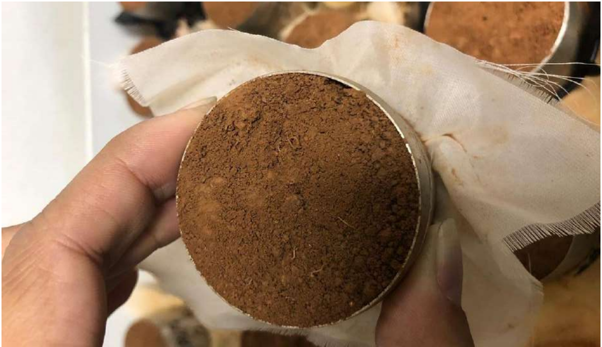
Figura 7. Preparo das amostras indeformadas para saturação com água e determinação da porosidade do solo na mesa de tensão. Rio Paranaíba – MG.
