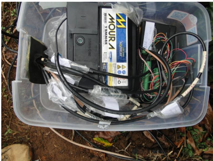
Figura 6 - Conjunto de sensores acoplados ao datalogger e à bateria para o armazenamento dos dados.
