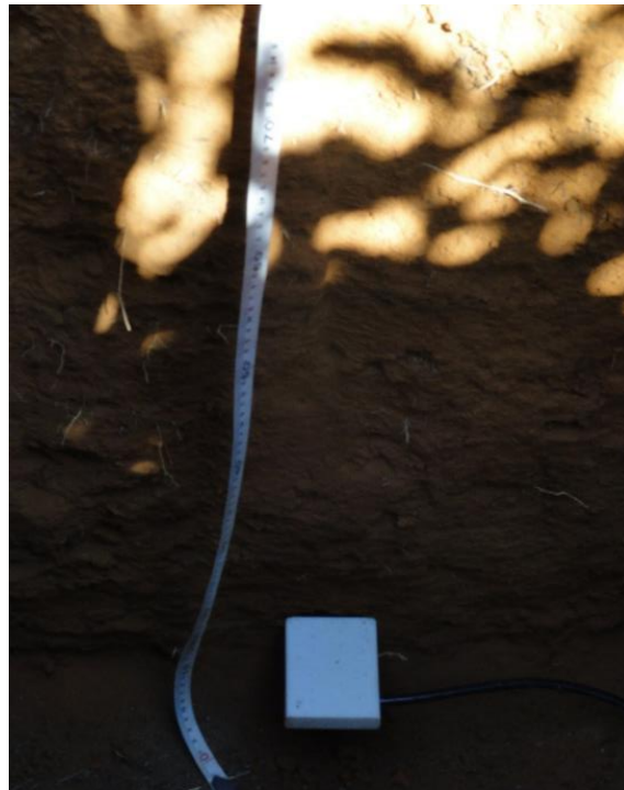
Figura 5 - Detalhe da instalação dos sensores de umidade e temperatura (tipo TDR) no interior da trincheira.
