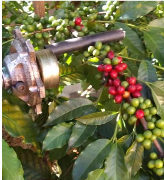
Figura 12 – Transmissão de vibração para o ramo do cafeeiro das soluções 3 e 4.
