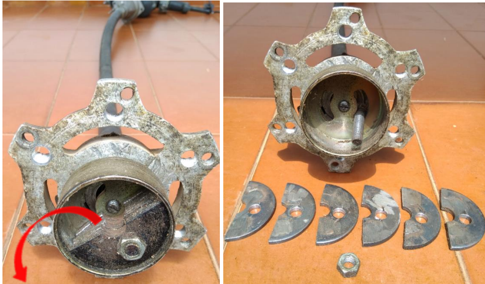
Figura 10 – Ponta flexível e suporte das massas desbalanceadas para as soluções 3 e 4.
