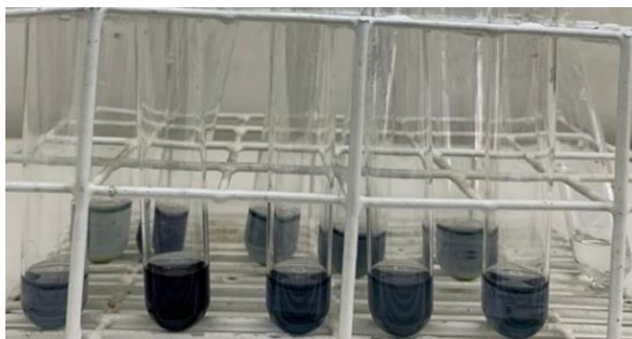
Figura 19 - Reação com coloração azul para construção da curva de calibração de FT
