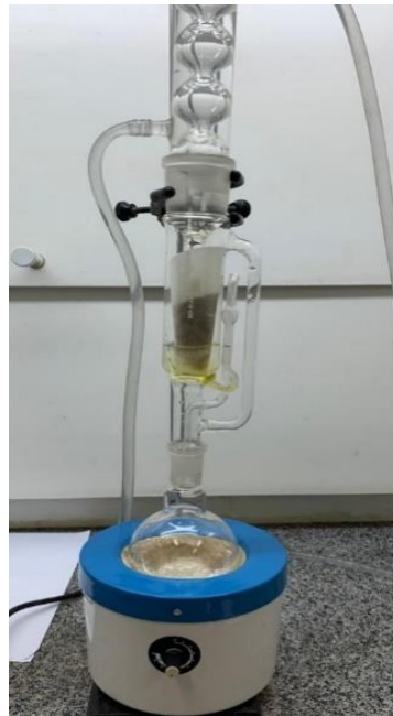
Figura 13 - Sistema de extração no Soxhlet para obtenção de lipídios
