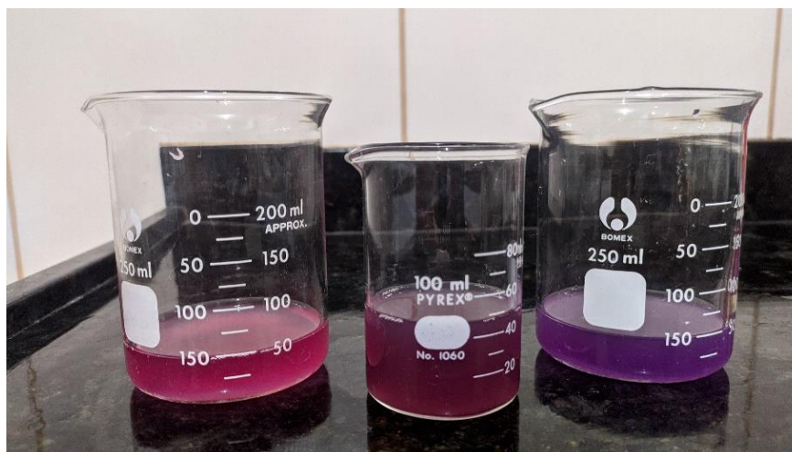
Figura 14. Diferentes amostras com a adição do suco de repolho roxo, indicando os diferentes valores de pH.
