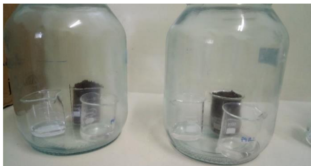
Figura 2. Recipientes utilizados para a incubação, juntamente com a amostra de solo e seus respectivos béqueres contendo NaOH e água.
