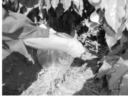
**Figura 1** - Coleta da vazão dos gotejadores.
