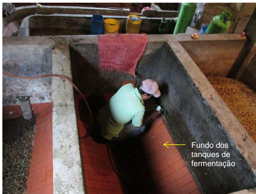
Figura 16 – Tanques de fermentação da instalação para processamento úmido de café, no município de Bello – tipologia 2.
