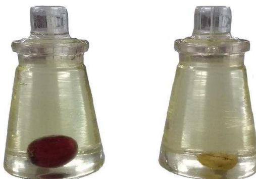
**Figura 6** – Determinação da massa específica unitária do frutos e grãos de café em picnômetro.
