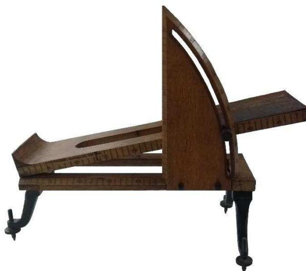
**Figura 7** – Plano inclinado com movimento de translação utilizado para determinação do coeficiente de atrito estático.
