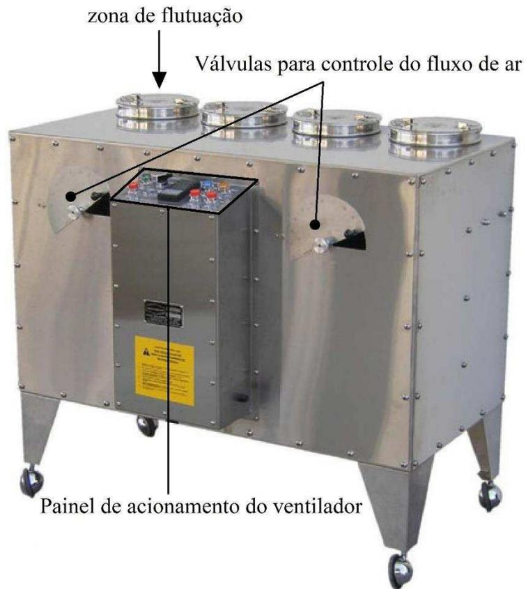
**Figura 8** – Equipamento utilizado para obtenção da velocidade terminal experimental.
