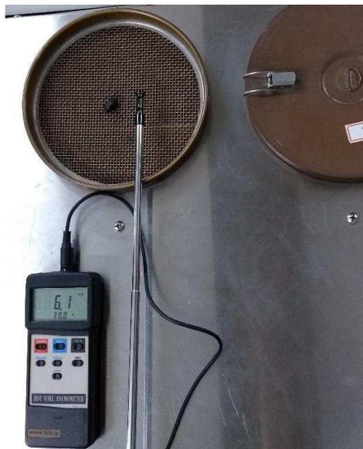
**Figura 9** – Aferição da velocidade terminal com termo-anemômetro digital de fio quente.
