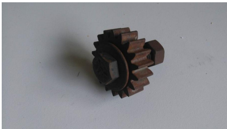
Figura 17 - Engrenagem para o sistema de transmissão dos roletes da mesa de separação de impurezas.
