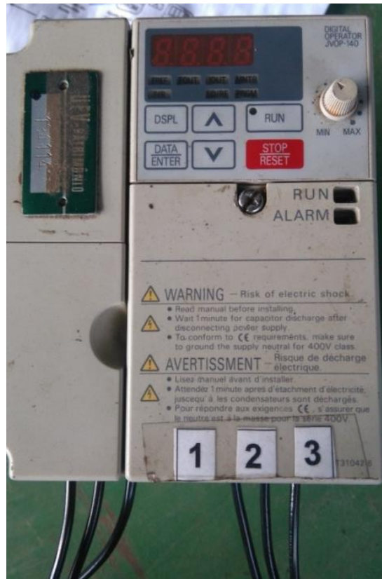
Figura 11 - Inversor de frequência modelo CIMR- V7AA21P5.
